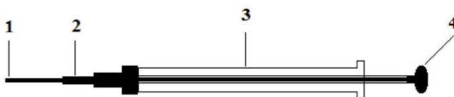
图 2 改装的固相微萃取装置 (1、萃取头; 2、针头; 3、针筒; 4、推杆帽)
