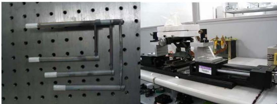
图 3-5 左图：5cm、8cm 及 11cm 的硅钨棒发热元件。右图：拉锥台全貌
