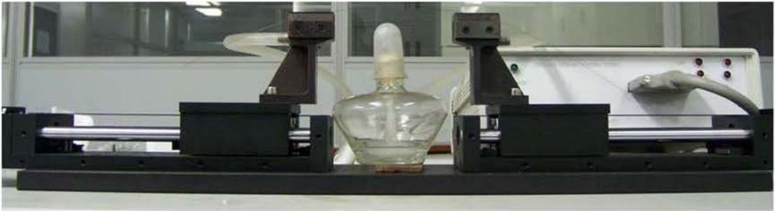
图 3-7 亚波长直径空心光纤的制备装置
