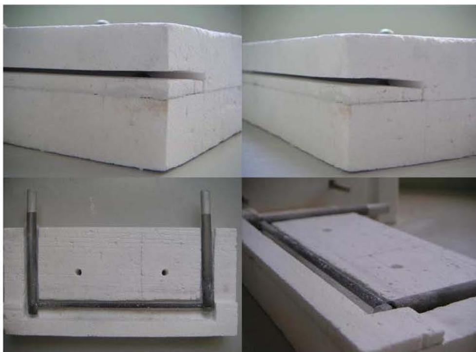
图 3-3 条形电加热炉
