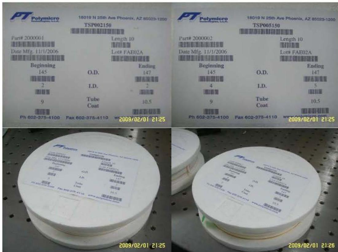
图 3-6 制备亚波长直径空心光纤所用的空心光纤
