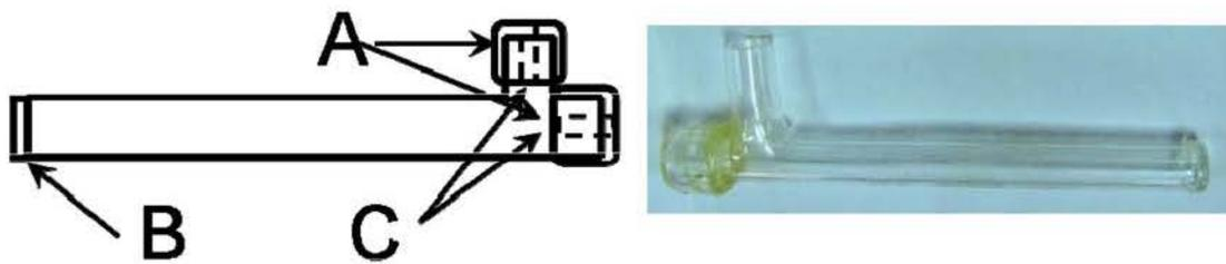
图 3-11 T-型三通管设计图和实物图
